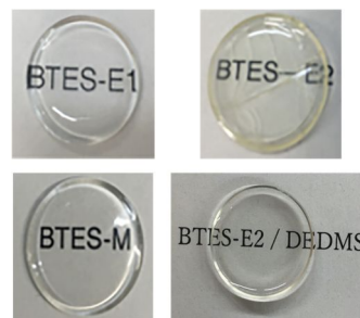
図4 架橋型ポリシルセスキオキサン自立膜の写真。
