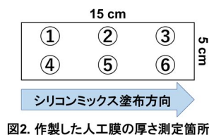
図2. 作製した人工膜の厚さ測定箇所
