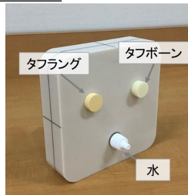
図2 製作した郵送ファントム
