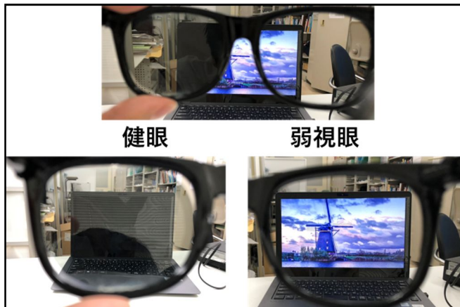
図 2：本研究で使用する偏光フィルムを用いた両眼開放下の弱視訓練装置 画面に偏光フィルムを貼付し、眼鏡の健眼側に 90 度反転させた偏光フィルムを貼付することにより、両眼開放下で弱視眼のみに視標を呈示することができる。これは紙媒体でも同様に行うことができる。
