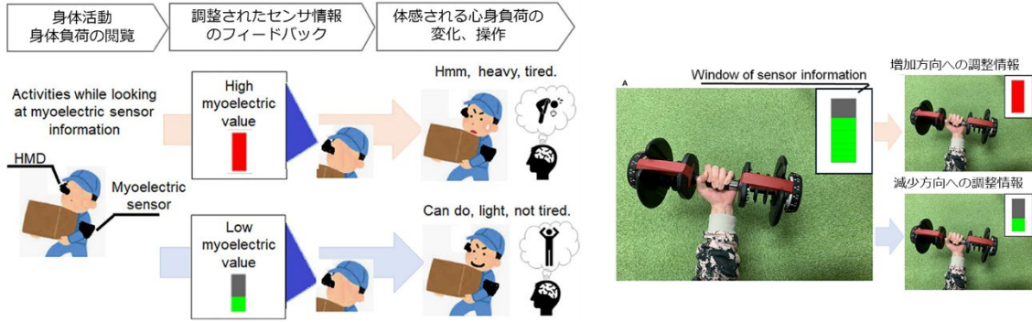
図 2: 筋電センサ情報の提示が起こす錯覚を利用した心身負荷の操作手法
