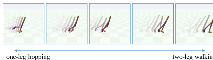
図 3 多様な歩行挙動を連続的な潜在空間を用いて学習した例 [Osa et al. Neural networks 2022]。
