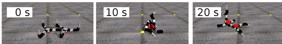
図1 提案法で獲得した5脚ロボットの転倒状態からの起き上がり動作
