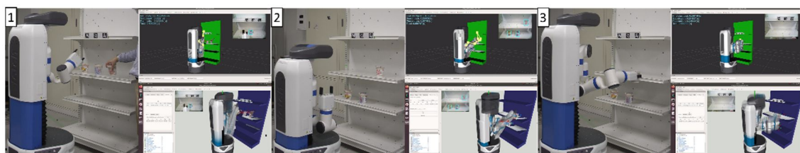
図4 商品陳列作業における自律的なエラー検出と遠隔指示によるリカバリ
