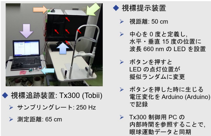
図 1 . 動的 HESS 試験の検査装置
