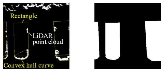
(a)LiDAR 点群からの輪郭推定 (b)生成された車両形状 図 5 並列駐車車両の正解形状生成
