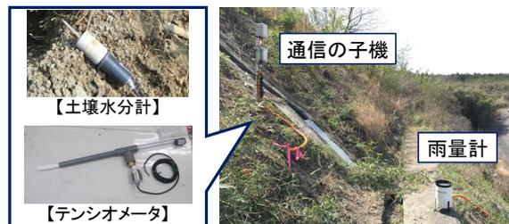
図-1 現地計測システム
