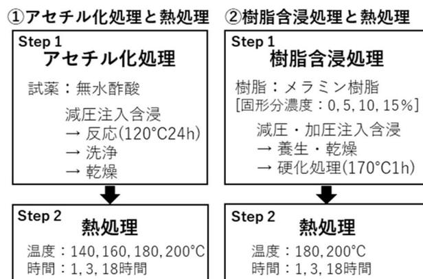
図1 本研究で行った2種類のツーステップ処理
