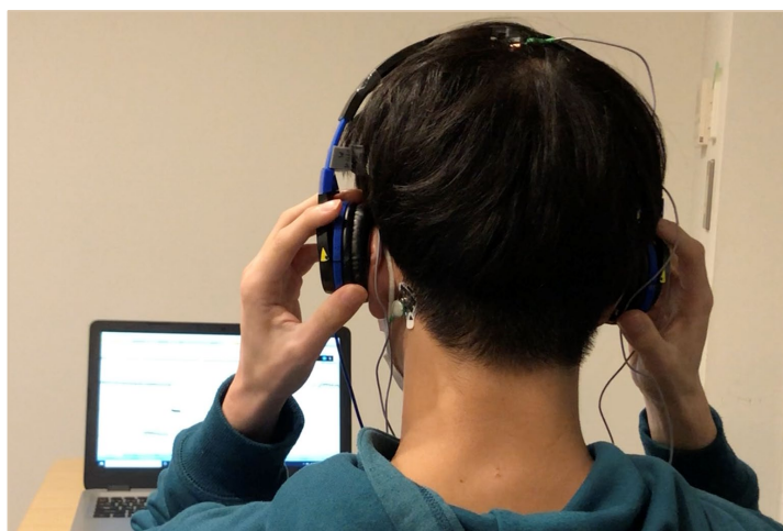
図 2. 30 秒で取り付け可能で、2 時間の継続的脳波計測が可能な脳波計測ヘッドセット
