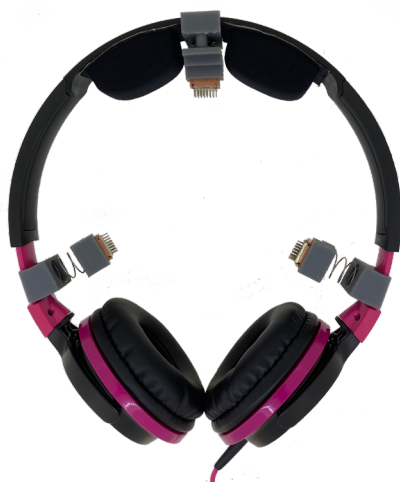
図 2. 30 秒で取り付け可能で、2 時間の継続的脳波計測が可能な脳波計測ヘッドセット
