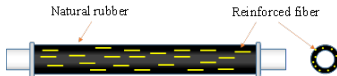
図 2 短繊維強化型人工筋肉
