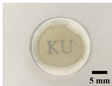
図 2 水熱ホットプレスにて緻密化された試料の光学顕微鏡写真
