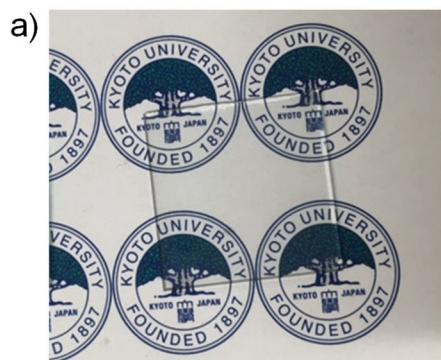
図3. a)透明な電子素子の写真、b) a)の活性層、電子輸送層を利用して作成した光電極の光電気化学測定結果
