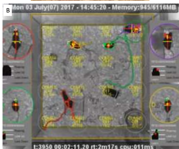
図1 複雑な社会性評価実験装置(A)。4匹のマウスが長期にわたり、同一空間で生活をするが、その間の個体位置がリアルタイムで記録される(B)。
