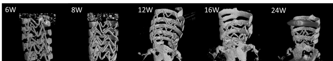
図6. ラット気管内に留置したポリ乳酸コーティング Mg 合金製気管ステントの \mu CT 画像
