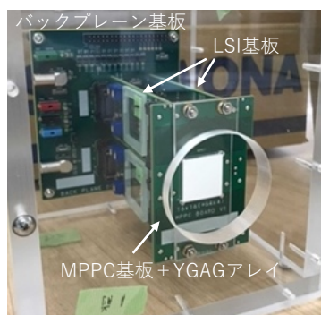
図7:(左)スケルトン筐体の実装したガンマ線イメージャー、(右) シールド・コリメータを実装した外観
