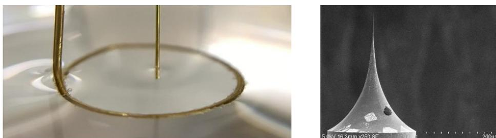
図 1(a) 自作の電気化学エッチング装置 (b) 作成した金の探針の SEM 画像
