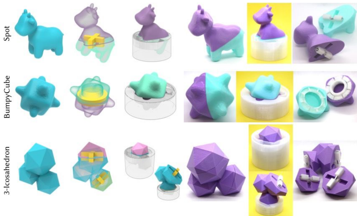
図3. 一般化遠心力パズルの生成結果。上段から順に、十字コア、円筒コア、マルチコアの生成結果例を示している。
