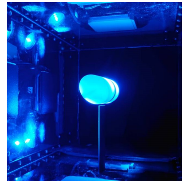
図 5 東北大学 0.3m MSBS に設置された模型(ダミーストラット付き)
