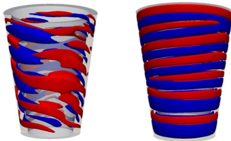
図 2 径方向に温度分布を与えた際の円錐型テイラー渦流の流動パターン (左: 粘度の温度依存性が強い流体、右: 粘度の温度依存性が弱い流体)
