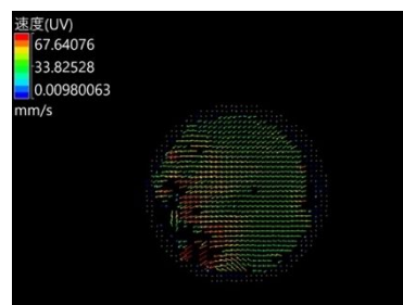
図 8 液滴底部の速度ベクトル (温度 140 )
