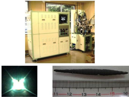
図3：テトラアーク炉の写真（上）、引き上げ法による単結晶の育成（下左）、育成されたUCoGe単結晶の写真（下右）
