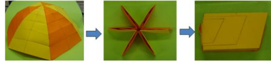
図9 実験室内に据えることを考えているジャバラ型ドーム
