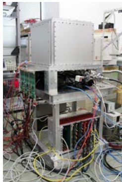
図 6：開発した気球搭載型 30cm 角コンプトンガンマ線カメラ。
