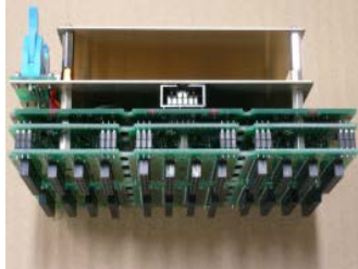
図 4：小型省電力化した光電子増倍管読出し回路。
