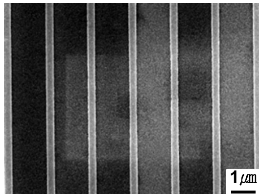
図3. ウォータージェット対向型粉碎システムとナノインプリントプロセスを併用することで得られた微細構造制御型アルミナのSEM像
