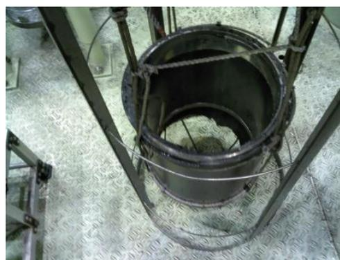
図3 上:セラミクス半球 2 個を組み合わせさせた水圧試験、中:セラミクス半球の間にセラミクス円筒胴を入れて水圧試験を行う、下:試験による圧壊後の形状。円筒胴は無傷で残っているが半球部は全壊した
