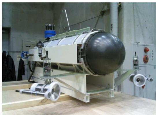
図2 前面をセラミクスドームとした AUV の概念図と実物写真、カメラは小型耐圧容器に入れ、レーザーと同方向に動く、海底地形詳細観測用カメラを装備して DVL に代用
