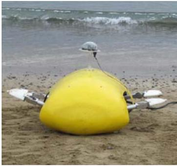
図5 カメラ型脚部を持つ水陸両用ロボット“RT-I”
