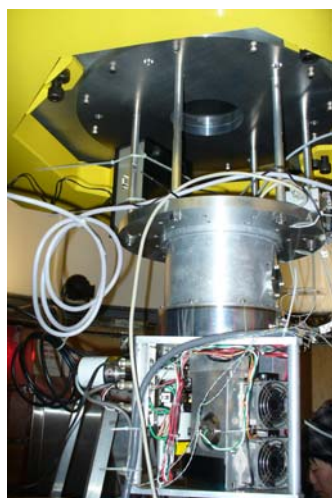
図 6：ハワイ大学望遠鏡に取り付けた赤外線カメラ
