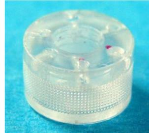
図7 軟組織接合試験用試験片
