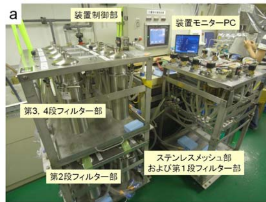
図2 みらい船内に設置した自動海水中溶存有機炭素フラクション大量ろ過装置
