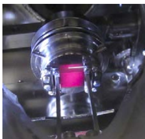
図 4. ストレス測定、RHEED の同時測定が可能な非固定式通電加熱装置
