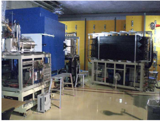
図7：実験のセットアップ写真：左側の青色の物がKappa磁石、右側が中性子検出器
