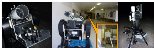
図5 完成した可搬紫外レーザー装置。左は射出光学系とガイド望遠鏡。中央はガイド望遠鏡とレーザーの光軸調整の様子。反射板に光軸調整用 He-Ne レーザーによるスポットが見える。右は装置全体の外観。ほぼ垂直方向に向けられた状態である。
