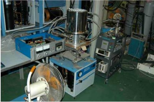
図 6 GM 冷凍機を使って種々の吸収体の低温特性を計測。
