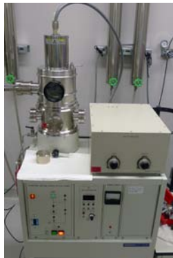
図5 セラミックスコーティング用スパッタリング装置
