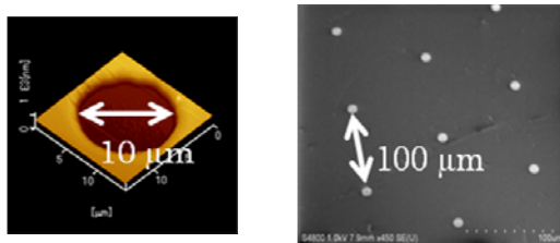
図6. 作製した MDA 電極の AFM 像 (左)。アレイの SEM 写真 (右)、ディスク直径 10 μm 間隔:100 μm, 個数:335 個
