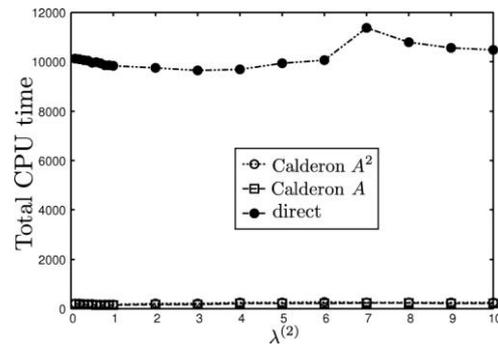
図8 Calderon 前処理と従来型前処理の CPU 時間の比較。  $\omega=8$ , 球の半径=0.31
