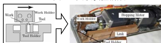
図2 二次元切削装置
