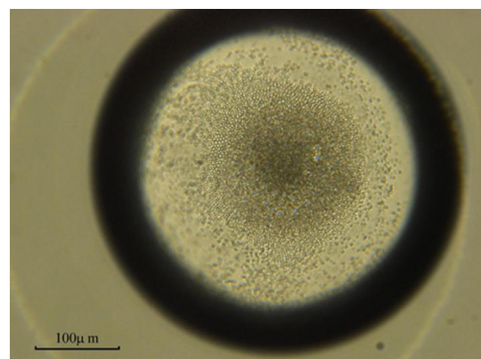
図3 膜材料溶液(ポリ乳酸の塩化メチレン溶液)の液滴内部に発生したマイクロバブル
