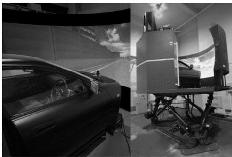
図3 ドライビングシミュレータ
