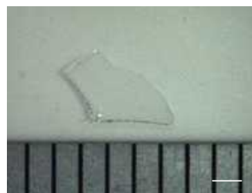
図 7 OC300 ガラス膜(厚さ 0.2 mm)
