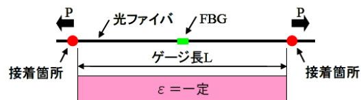
図-1 ロングゲージ FBG センサの概念
