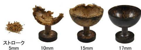
図 10 素材の金型への充填の様子
