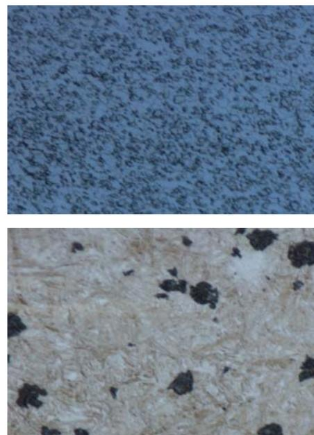
図 3 (a)  $A_1$  点以上と (b)  $A_1$  点以下で接合した SK85 継手の断面における組織
