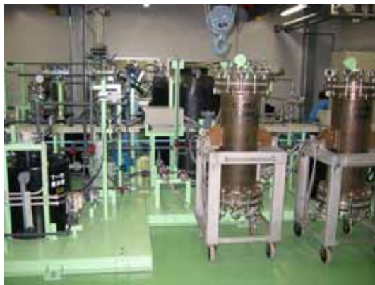
図3 海水からのレアメタル回収用パイロットプラント
