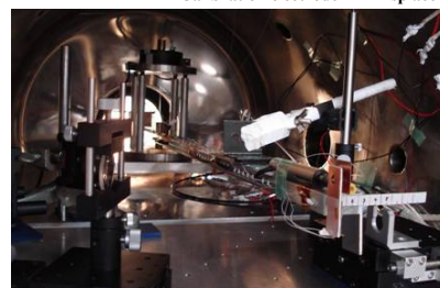
図3 微小推力測定装置（上図：模式図，下図真空槽に設置した様子）。
