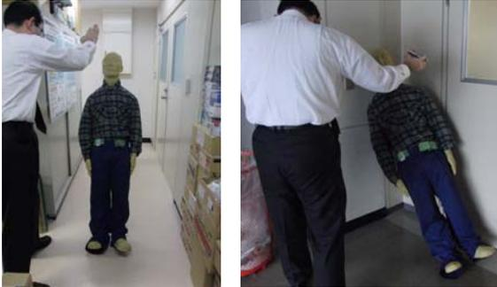
図 3 ダミー人形による転倒実験
