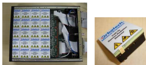
図 1 半導体検出器ユニットと検出器モジュール
